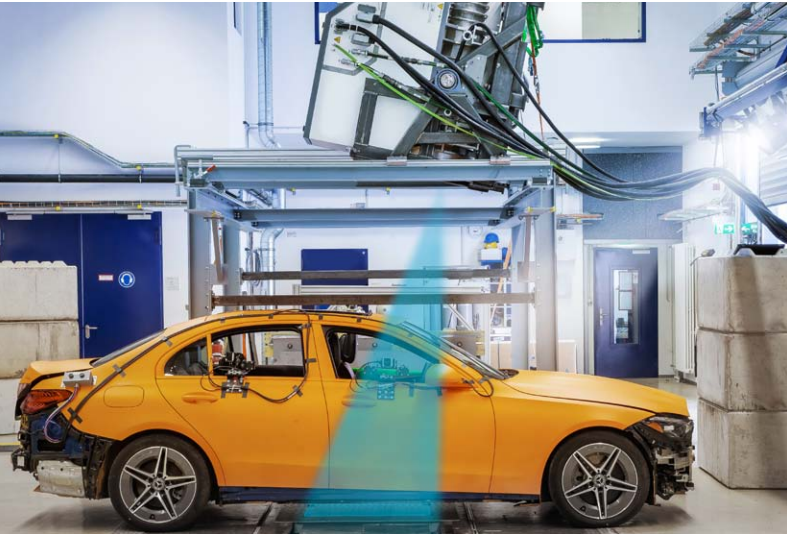
Crashtest mit Linearbeschleuniger: am Fraunhofer EMI entwickeltes Verfahren.
