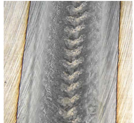
Mit 120 kW Laserleistung lokal schnell gehärtetes Stahlwerkstück.
