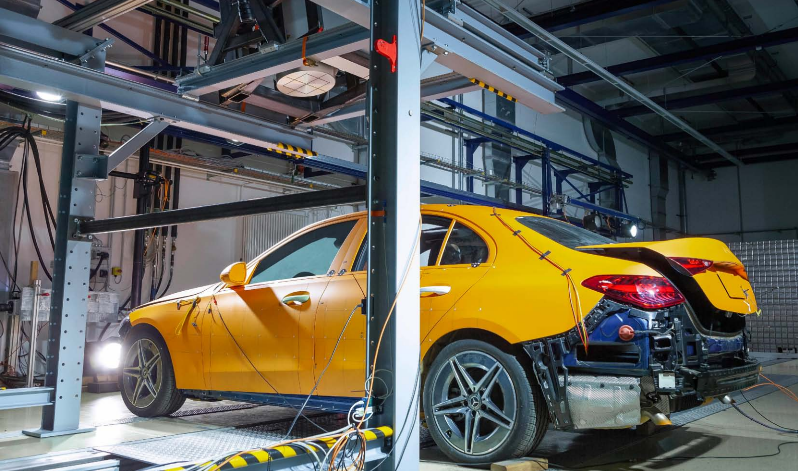
Forschungscrashanlage am Fraunhofer EMI: In der Forschungscrashanlage werden Impactversuche auf Bauteil- und Gesamtfahrzeugebene mit Impactmassen bis zu 3 t und Geschwindigkeiten bis zu 80 km/h realisiert. Im Bild: Gesamtfahrzeugversuch mit Einsatz eines Linearbeschleunigers.
