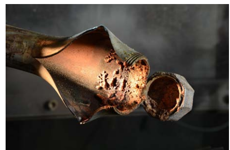
Durch Laserneutralisation aufgerissenes Rohrbombenmodell.
