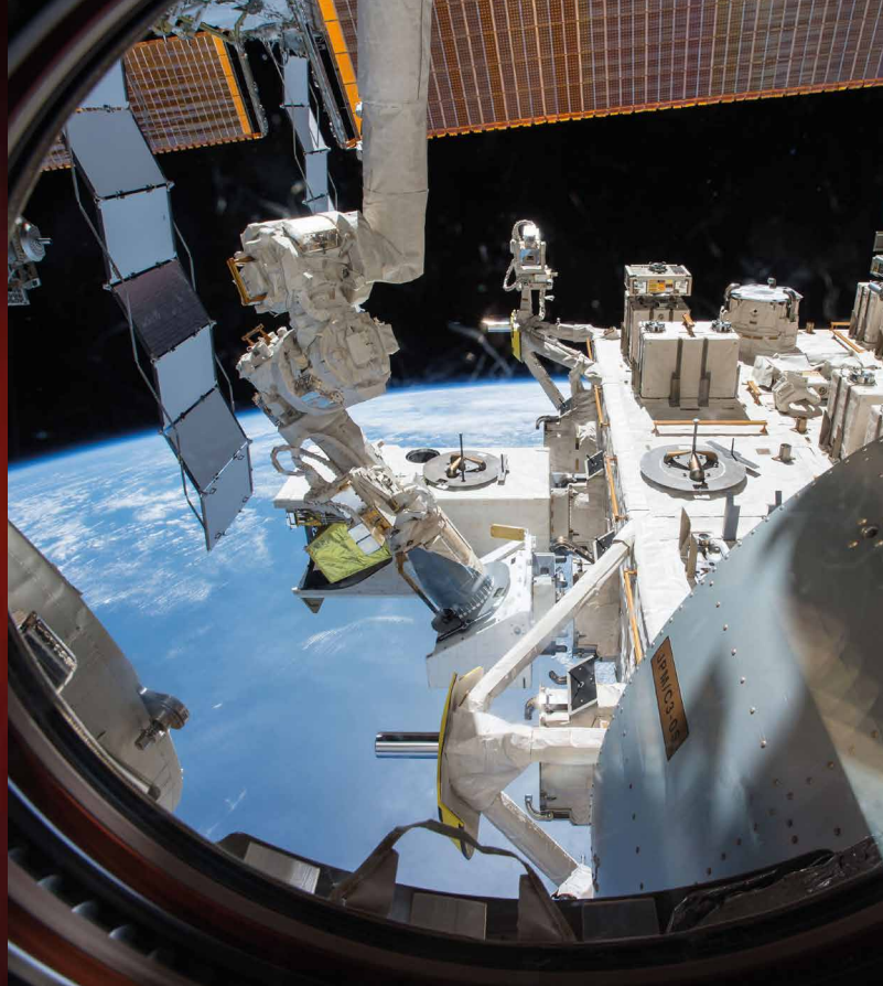
In der Bildmitte ist die externe Plattform von NanoRacks (NREP) auf der ISS zu sehen, auf der bald die EMI-Nutzlast installiert sein wird. © NASA
