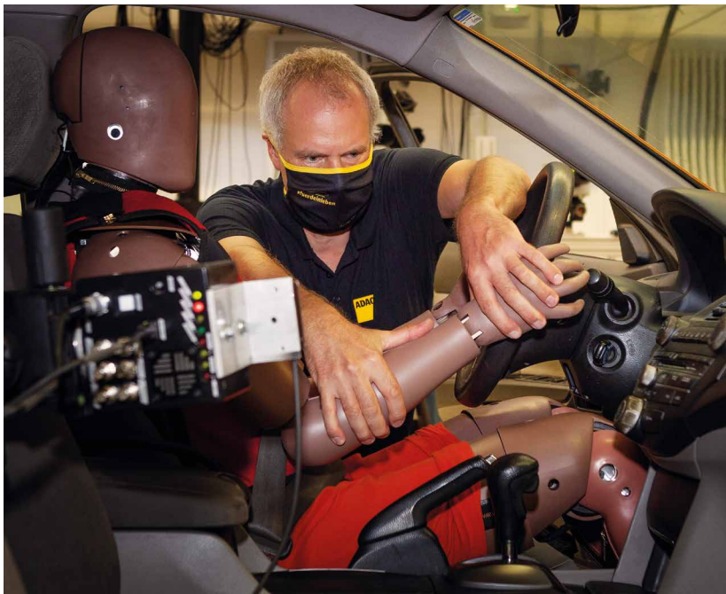
Der Dummy THOR-50M wird für den Röntgen-crashtest präpariert.
