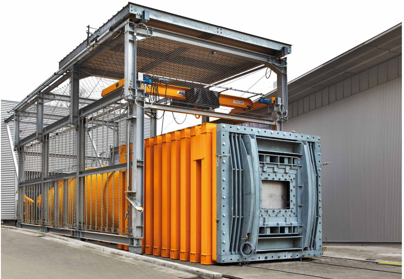
Mit der Stoßrohranlage BlastStar können am Fraunhofer EMI Stoßwellenbelastungen infolge von Sprengstoff- und Gasexplosionen simuliert werden. Die gewonnenen Erkenntnisse dienen dazu, eingesetzte Materialien und Strukturen zu optimieren.
